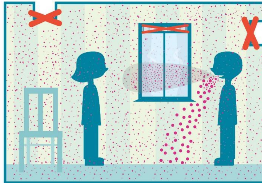
Geen ventilatie of verluchting
